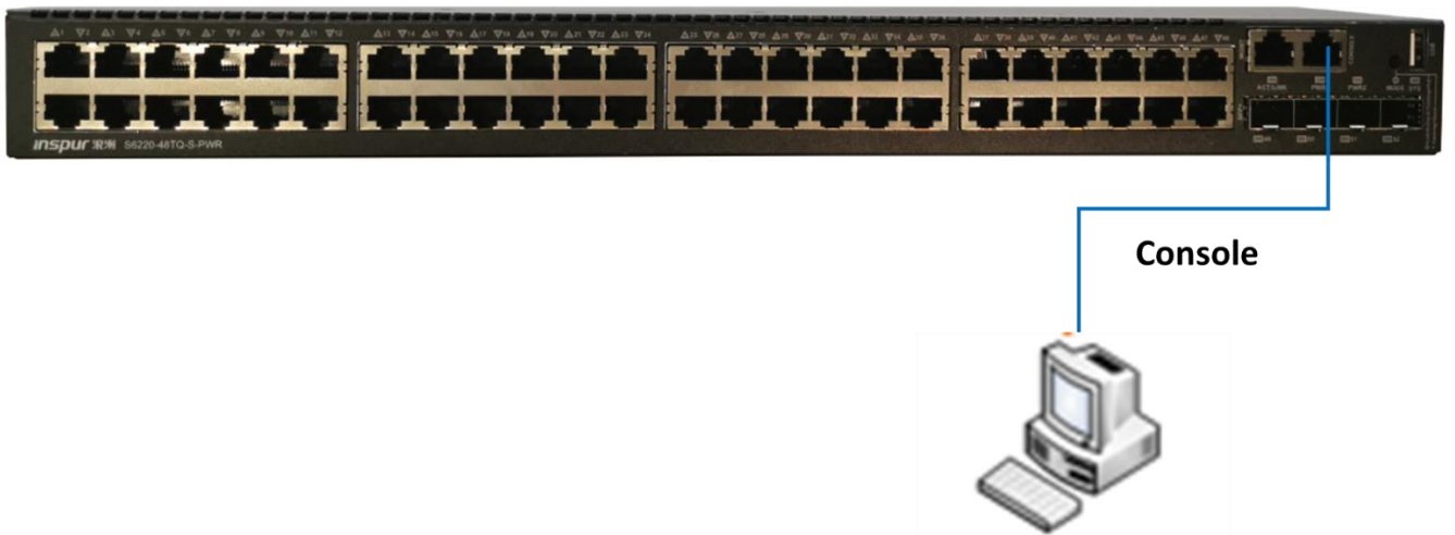
图 3-1 通过 Console 口搭建本地配置环境
