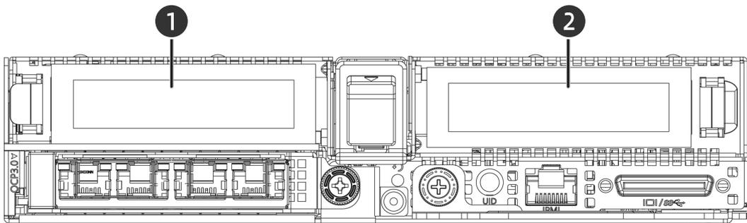
PCIe Riser 模组 1、2 提供的槽位为 PCIe0\_CPU1、PCIe1\_CPU0。
