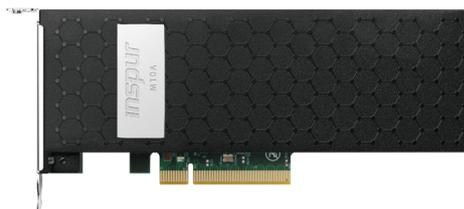
M10A是浪潮新一代面向全场景视频AI应用的高密度VPU(Video Processing Unit)加速卡，率先在8W超低功耗实现16路1080P全高清视频实时编解码，支持超强的H.265视频编码算法，使网络带宽利用率翻倍，计算CPU负荷最低可降至2%，完整支持主流视频处理框架FFMPEG，为用户打造“零”开发成本的极致体验。M10A支持当前最先进的视频编码技术，覆盖全场景视频AI加速需求，全面增强数据中心视频业务处理能力。
