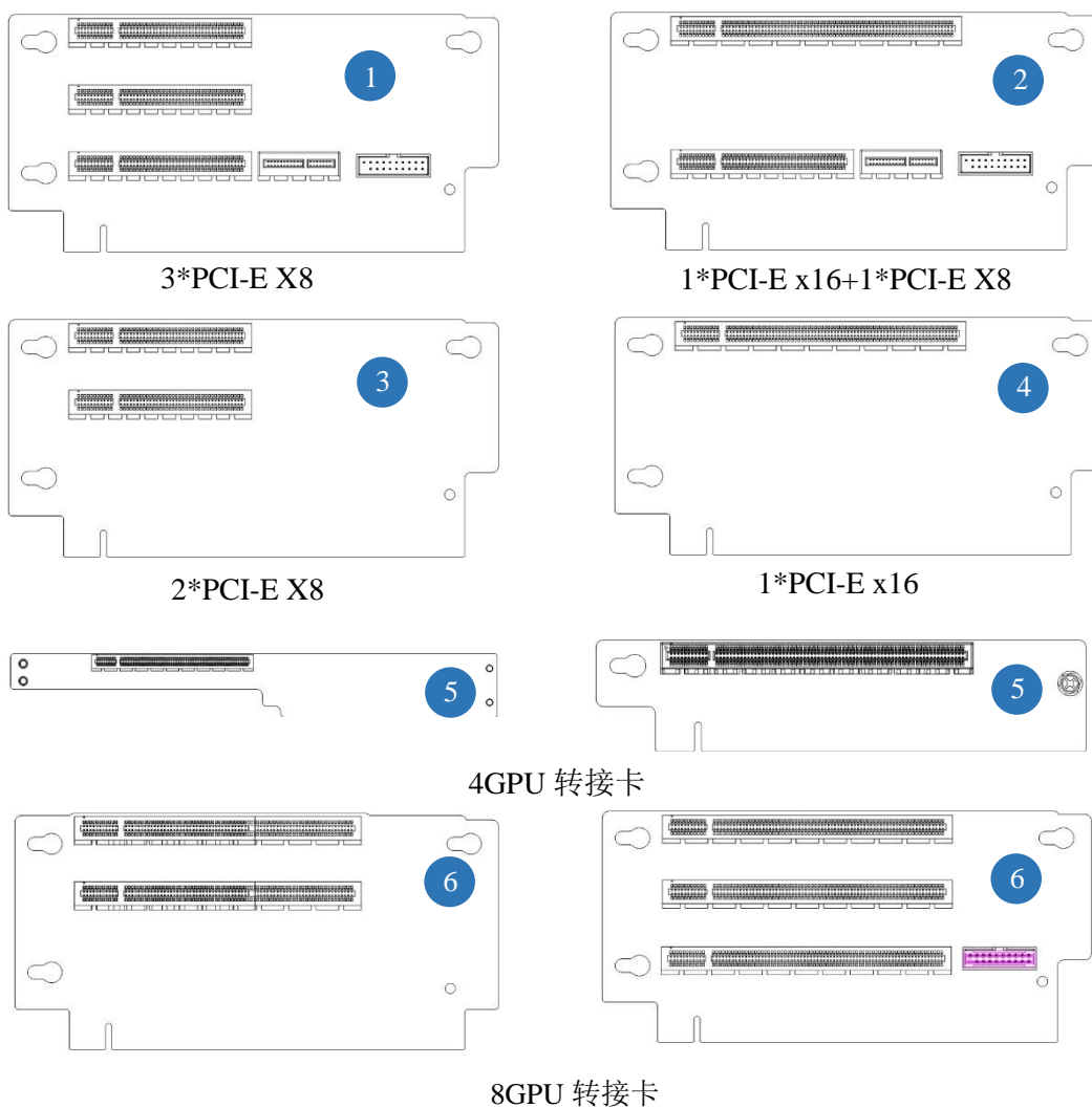
图 错误!文档中没有指定样式的文字。-7 PCI-E 转接卡示意图
