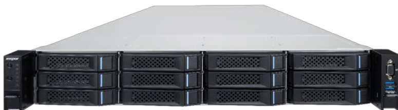
图1-1 前置3.5寸硬盘机箱外观图
