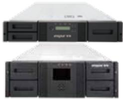
物理带库TL1000/TL2000可提供8Gb光纤通道和6Gb SAS 接口，可连接到多种开放式系统服务器，采用主流的LTO7、LTO6、LTO5磁带驱动器，能够满足客户备份、恢复和归档数据的需要。
