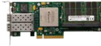
支持OpenCL高级语言开发，业界功能密度最高、性能最强的半高半长FPGA板卡。
