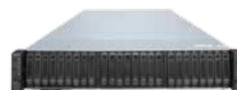
NF5280M5是浪潮专为全新AI应用优化的2U双路机架高端产品，支持全球最先进的 Intel® Xeon® Skylake处理器，在2U机箱内支持4片GPU加速卡，其高品质、高可靠的表现，适用于各类对计算、存储、通讯有高要求的应用。
