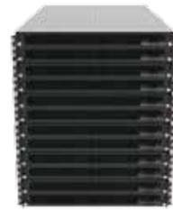
OB5161M4是一款参照Open19标准开发的1U全宽尺寸存储服务器节点，基于Intel® Grantley平台CPU，可以支持硬盘热拔插，搭配Open19交换机和供电等部件可以组成完整的服务器系统。
