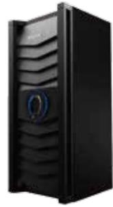
AS18000是面向关键业务需求的高端存储系统，是浪潮发布的一款高端多控融合存储系统平台。AS18000是多控体系架构，各控制器间负载均衡。同时融合iSCSI、FC、FCoE及10Gb万兆主机接口，囊括了目前主流的存储网络架构及主机连接方式。
